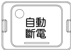
[ON] 如操作中出现 ALARM，或無操作動作時，經過設定時間後，機台會自動斷電。機台出廠時設定時間是 20 分鐘。
