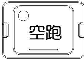
[ ON ] 當此按鍵 ON 時，刀台進給速度由進給速率旋鈕控制，以代替程式指令中之 F。而且快速定位是有效的。
