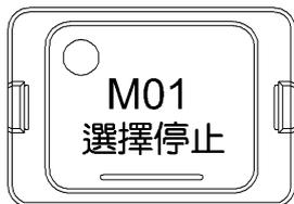
[ ON ] 當此按鍵 ON 時，當程式讀到 M01 指令時，會立即將主軸、刀塔和切削水等動作停止。再壓下循環啟動按鍵後，程式才繼續執行。
